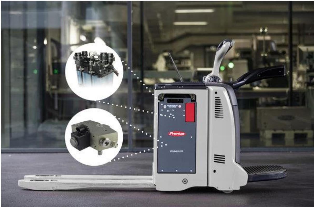
Komponenten des Brennstoffzellensystems / Kreis unten: Tankventil mit integriertem Druckregler / Kreis oben: Medienmodul.
